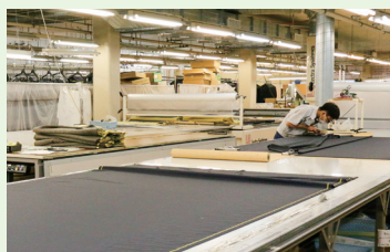
▲大型スチーム機で反物の生地のしわをなくした後、自動裁断機で裁断します
